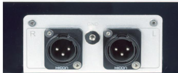
Wahlweise wird das Laufwerk mit symmetrischen oder unsymmetrischen Tonabnehmerbuchsen auf dem Anschlussfeld ausgeliefert.
